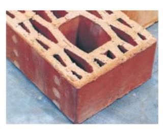
Con un cambio en la forma de las celdas del ladrillo usado actualmente en Chile, investigadores de dos universidades chilenas lograron mejorar los valores de transmitancia térmica de la albañilería de muros, logrando así cumplir con las modificaciones a la Ordenanza General de Urbanismo y Construcciones (OGUC).
